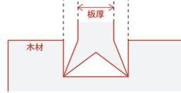
刃を左右に広げるアサリ加工をする事で、材料との接地面が少なくなり抵抗が抑えらる。また大鋸屑の排出も良くなるメリットがある。広げる量が大きすぎると鋸刃が安定せず切りにくくなり、反対に狭すぎると鋸刃が挟まり動けなくなる。板厚に応じて最適な量の幅に設定。板厚より切幅は大きくなる。
