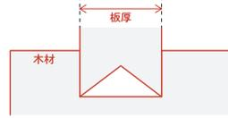
剪定鋸は、刃を左右に広げるアサリ加工を行っていない。刃部の厚みは板厚と同様。バックテーパ加工により刃の部分が背の部分より広い為、アサリの役目を果たしている。刃を広げない為、対象物に傷をつけにくく大きい目立の鋸でも、切り口が綺麗に仕上がる。※レザソー-細工鋸の片刃・両刃はダボ挽の使用の際、材料に傷がつかないように配慮している。
