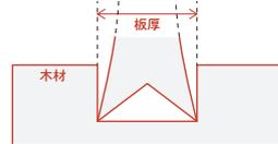
刃の先端部(エッジ)の板厚を広くし、刃の反対側へ行くほど板厚が薄くなる加工。研磨仕上げで加工するため刃のラインが均等になり、剪定用などの大きなピッチの刃でも切り口を綺麗に仕上げる事が可能。林業での枝打ち作業に適している。切り口を綺麗に仕上げる事で、樹皮の再生が良好になり、中心部の黒くなるボタン材などの発生を予防。
