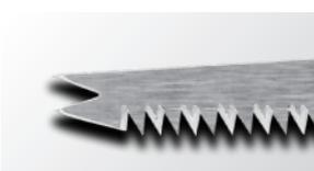
先端 V カット刃により穴あけ加工が簡単、スピーディーに。飛びアサリ入りの鋸刃が一般木材はもちろん、塩ビパイプもストレスなく切断。
